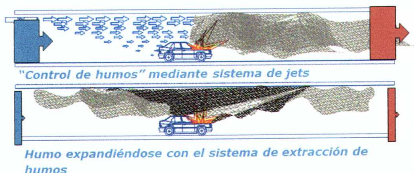
Figura 1: Los sistemas jet fan no son adecuados para garantizar al evacuación de ocupantes, por su efecto lanza en la parte delantera, que inutiliza la vía de evacuación.
